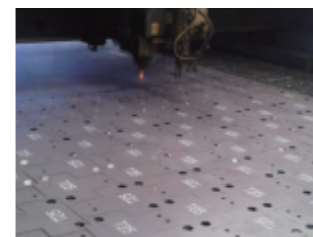
溶断製品(レーザー切断)
