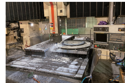
▲切削・フライス (免震フランジ)
