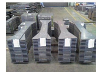
溶断製品(ガス切断)
