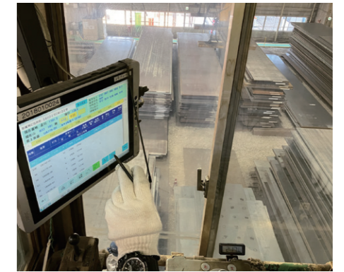
▲データトラッキング（クレーン）
